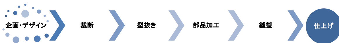
図 5-2：かばん製造工程の一例（株式会社 ADACHI の HP を参考に著者作成 60) ）
