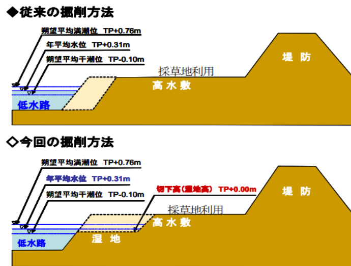
図 6-4 立野地区での環境に配慮したものと一般的な場合での掘削断面図 (出典：：近畿地方整備局，円山川水系河川整備計画より 77) )
